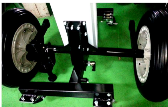
Chassis coulissant avec 4 roues et frein à pied
